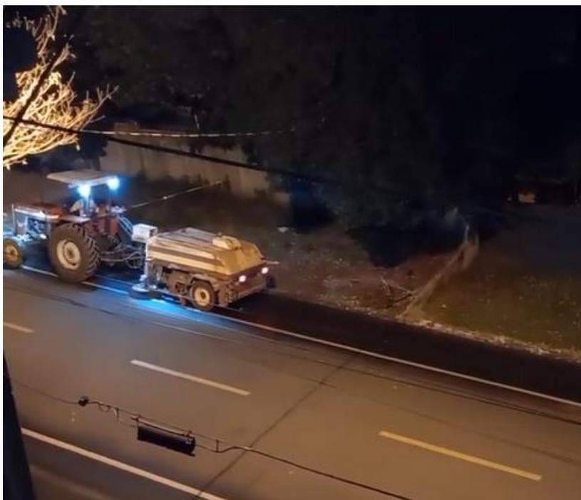
**Figura 6.26.** Serviço de varrição com purtrator mecânico.
